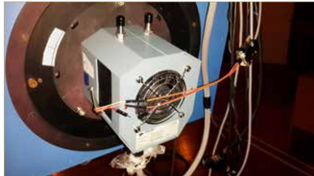
TFOSC'ta kullanılan yeni ANDOR CCD Kamerası
