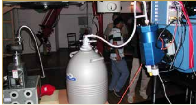
TFOSC'un eski CCD kamerası ve azot dolum sistemi
